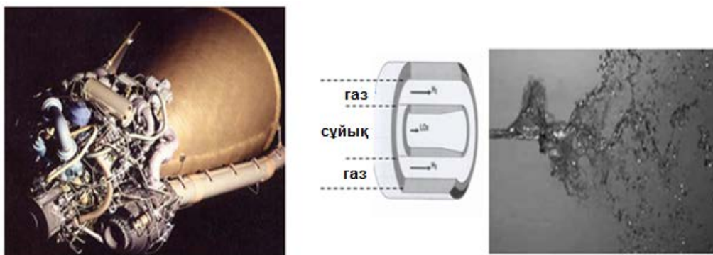
2-сурет – Реактивті іштен жану қозғалтқышындағы отынды бүрудің мысалы
