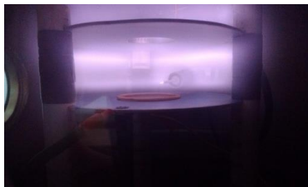
Рисунок 3 – ВЧ компенсированный зонд в рабочем режиме в плазме аргона
