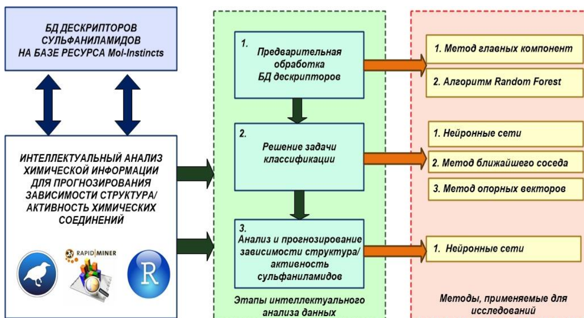
Рисунок 1 – Этапы интеллектуального анализа химической информации для прогнозирования зависимости «структура/свойство» сульфаниламидов
