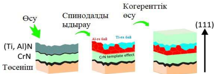
5-сурет – (TiAlSiY)N/CrN жабынының фазалық бөліну мен өсуінің сызбалы түрде ұсынылған механизмі
