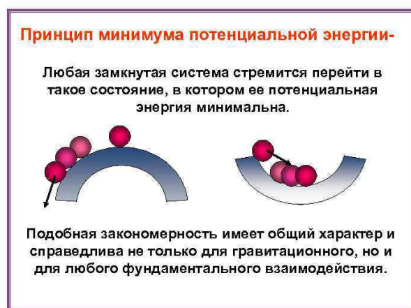
Рисунок 1 – Тенденции устойчивости механической системы с максимумом (слева) и минимумом потенциальной энергии
