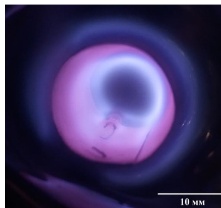
Рисунок 2 – Внутренность полого катода во время эксперимента, вид с торца катода
