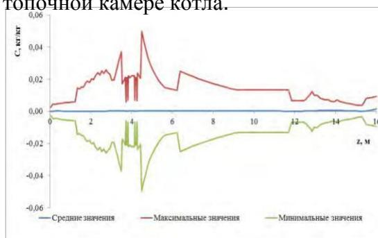
Рисунок 3 – Зависимость концентрации углерода по высоте камеры сгорания
