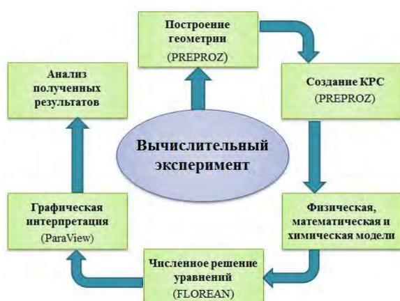
Рисунок 1 – Этапы проведения вычислительного эксперимента
